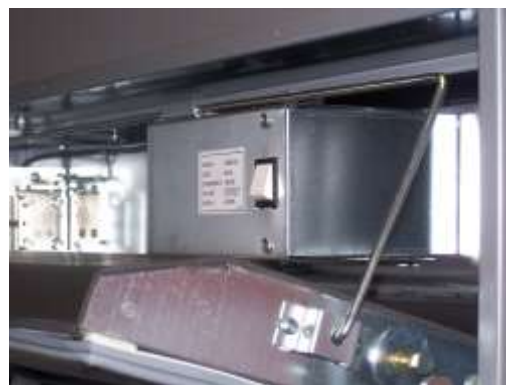
FIG. 5.2 - A) INTERRUPTORE SPORTELLLO DI VENDITA B) TERMOMETRO
