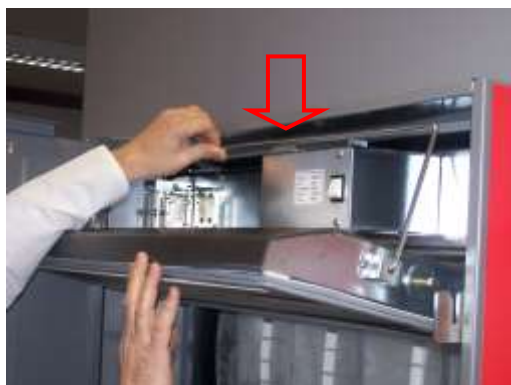
FIG. 5.2 - A) INTERRUPTORE SPORTELLLO DI VENDITA B) TERMOMETRO
