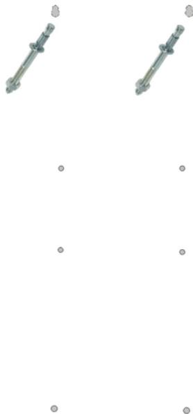
**4. Zwei Schrauben mit den zugehörigen Dübeln in die beiden oberen Bohrlöcher einsetzen und festschrauben.**
