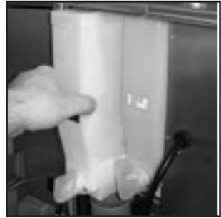
**Achtung:** Bei bestimmten Produkten (z.B. Milchpulver) müssen die Produktbehälter im regelmäßigen Turnus auch innen gereinigt und desinfiziert werden. Leeren und spülen Sie die Produktbehälter. **Trocknen Sie die Behälter gründlich. Setzen sie die Behälter erst vollständig getrocknet wieder in den Automaten ein!**
