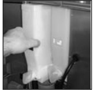
2. Entfernen Sie die drei Auslaufschläuche von den Auslaufrohren. Entfernen Sie die Auslaufrohre vom Kunststoff-Ausgabekopf. Entfernen Sie die Absaughaube / die Mischschale (siehe Abbildung) und **den** Auslaufschlauch von der **Mixerfassung**. Reinigen Sie den Kunststoff-Ausgabekopf gründlich mit einem desinfizierten Tuch.
