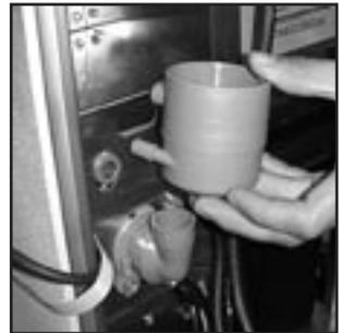
3. Entfernen Sie die gesamte Mixereinheit mit Mixerfassung (siehe Abbildung). Zerlegen Sie die Mixereinheit in ihre Einzelteile – Mixerfassung, Mischkammer, Absaughaube und Mixerscheibe. Reinigen Sie alle Komponenten des Mischsystems in der Desinfektionslösung Spülen Sie alle Komponenten mit sauberem Wasser ab und trocknen Sie diese gründlich, bevor Sie diese wieder in den Automaten einsetzen.
