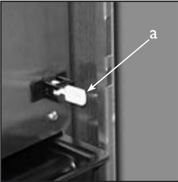
1. Setzen Sie den Sicherheitsschlüssel (a) ein, um die Stromversorgung wiederherzustellen.
