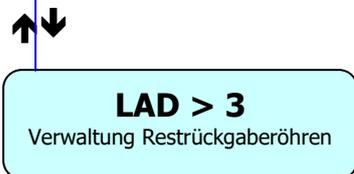
Mit dem Menü **LAD > 3** kann man mit der Hand die Restrückgaberöhren laden (**LAD > 3.1**) oder entleeren (**LAD > 3.2**).
